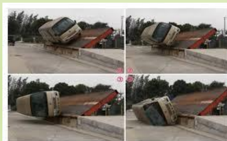
▲ GB 1775.18-1998《客车上部结构与强度试验》标准中规定的大客车翻翻试验。（图片来源：汽车之家）
